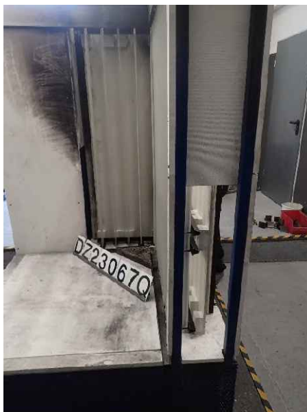
Foto 7: DZ3.1/23-067Q („V-200“), Ansicht des Luftspalts des großen Flügels vor der Brandprüfung.
