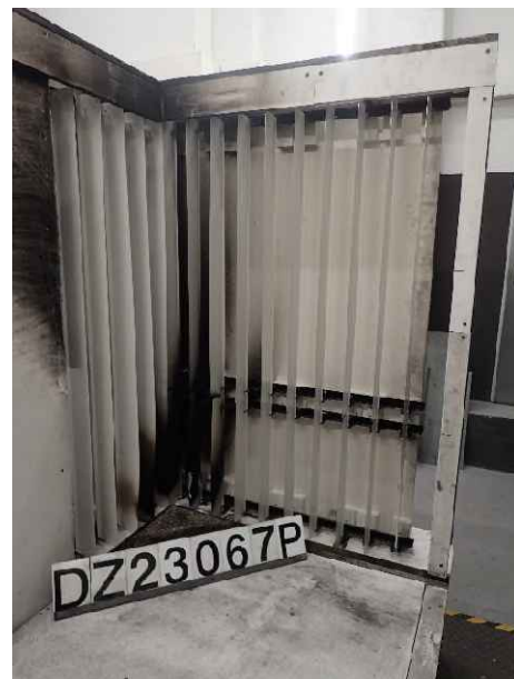
Foto 4: Prüfkörper DZ3.1/23-067P („V-200“), Ansicht nach der Prüfung.
