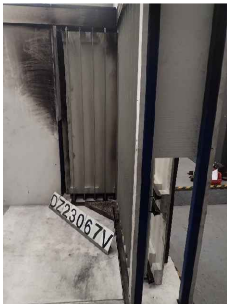
Foto 23: DZ3.1/23-067V („V-200“), Ansicht des Luftspalts des großen Flügels vor der Brandprüfung.
