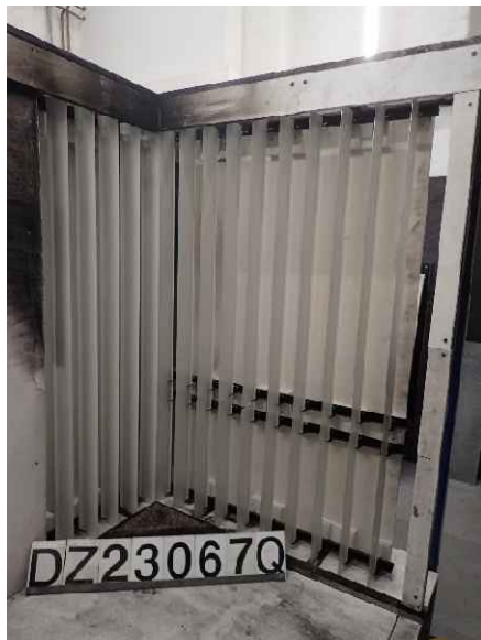
Foto 5: Prüfkörper DZ3.1/23-067Q („V-200“), Ansicht des großen Flügels vor der Brandprüfung.
