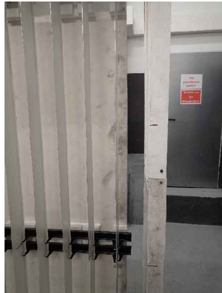
Foto 10: Prüfkörper DZ3.1/23-067R („V-200“), Detailansicht der Außenkante des breiten Probenflügels in Höhe von 500 mm in einem Winkel von ca. 45° vor der Brandprüfung.
