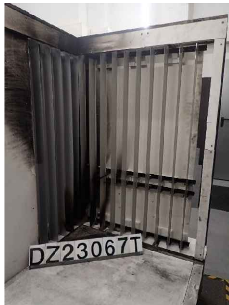
Foto 20: Prüfkörper DZ3.1/23-067T („V-200“), Ansicht nach der Prüfung.
