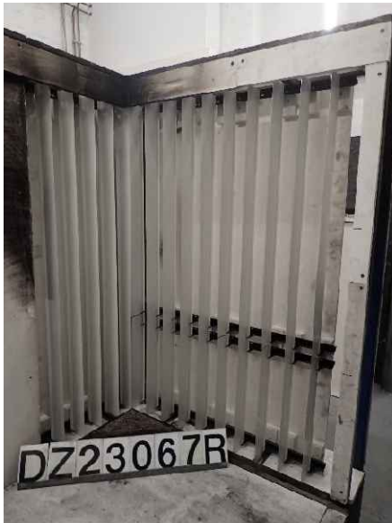
Foto 9: Prüfkörper DZ3.1/23-067R („V-200“), Ansicht des großen Flügels vor der Brandprüfung.
