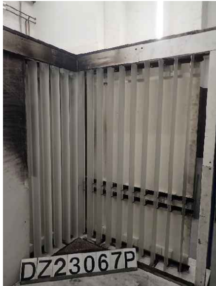
Foto 1: Prüfkörper DZ3.1/23-067P („V-200“), Ansicht des großen Flügels vor der Brandprüfung.
