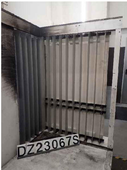
Foto 13: Prüfkörper DZ3.1/23-067S („V-200“), Ansicht des großen Flügels vor der Brandprüfung.
