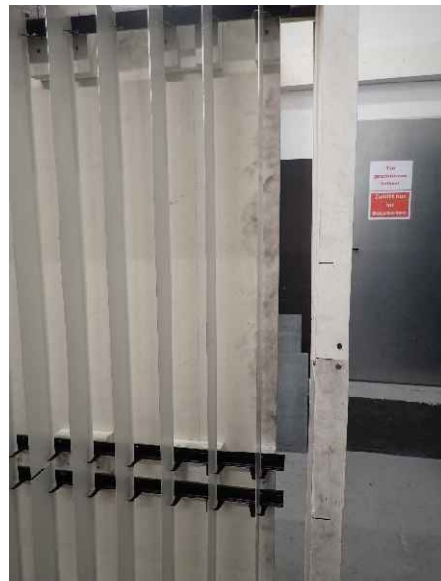
Foto 6: Prüfkörper DZ3.1/23-067Q („V-200“), Detailansicht der Außenkante des breiten Probenflügels in Höhe von 500 mm in einem Winkel von ca. 45° vor der Brandprüfung.
