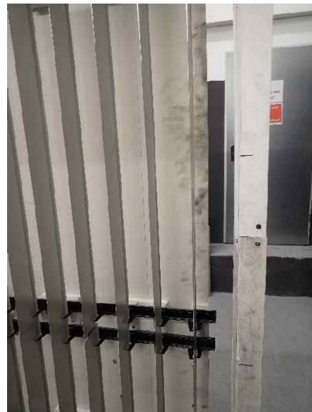
Foto 18: Prüfkörper DZ3.1/23-067T („V-200“), Detailansicht der Außenkante des breiten Probenflügels in Höhe von 500 mm in einem Winkel von ca. 45° vor der Brandprüfung.
