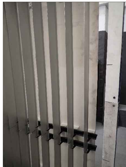
Foto 14: Prüfkörper DZ3.1/23-067S („Lamelle“), Detailansicht der Außenkante des breiten Probenflügels in Höhe von 500 mm in einem Winkel von ca. 45° vor der Brandprüfung.
