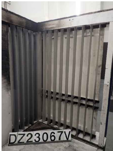
Foto 21: Prüfkörper DZ3.1/23-067V („V-200“), Ansicht des großen Flügels vor der Brandprüfung.
