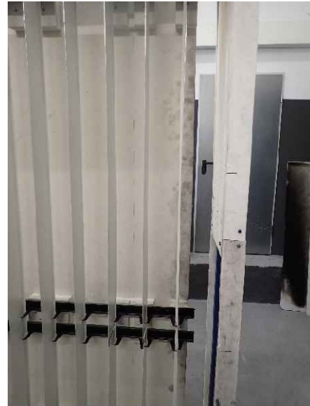
Foto 2: Prüfkörper DZ3.1/23-067P („V-200“), Detailansicht der Außenkante des breiten Probenflügels in Höhe von 500 mm in einem Winkel von ca. 45° vor der Brandprüfung.
