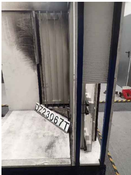
Foto 19: DZ3.1/23-067T („V-200“), Ansicht des Luftspalts des großen Flügels vor der Brandprüfung.
