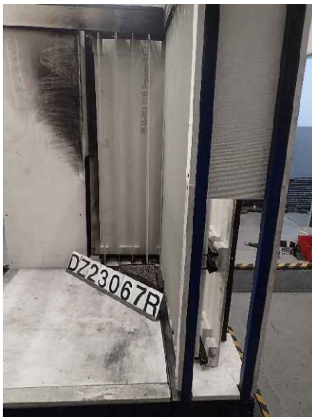
Foto 11: DZ3.1/23-067R („V-200“), Ansicht des Luftspalts des großen Flügels vor der Brandprüfung.
