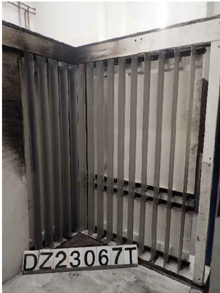
Foto 17: Prüfkörper DZ3.1/23-067T („V-200“), Ansicht des großen Flügels vor der Brandprüfung.
