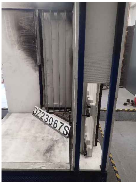
Foto 15: DZ3.1/23-067S („Lamellen“), Ansicht des Luftspalts des großen Flügels vor der Brandprüfung.
