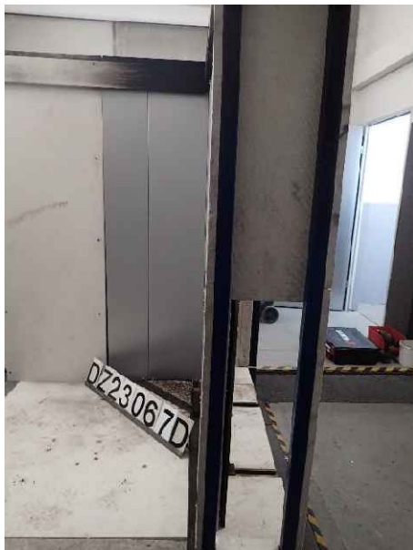
Foto 3: DZ3.1/23-067D („K-284“), Ansicht des Luftspalts des großen Flügels vor der Brandprüfung.
