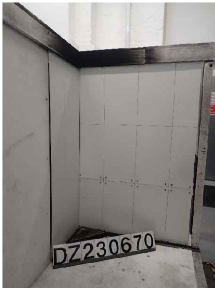
Foto 21: Prüfkörper DZ3.1/23-0670 („K-284“), Ansicht des großen Flügels vor der Brandprüfung.
