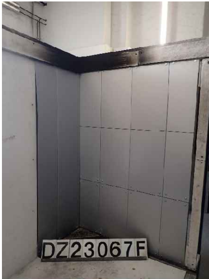
Foto 9: Prüfkörper DZ3.1/23-067F („K-284“), Ansicht des großen Flügels vor der Brandprüfung.
