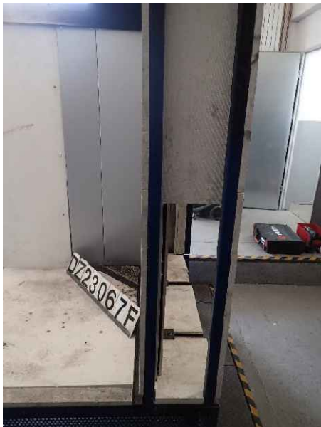
Foto 11: DZ3.1/23-067F („K-284“), Ansicht des Luftspalts des großen Flügels vor der Brandprüfung.
