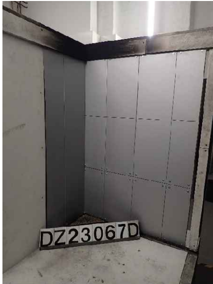
Foto 1: Prüfkörper DZ3.1/23-067D („K-284“), Ansicht des großen Flügels vor der Brandprüfung.
