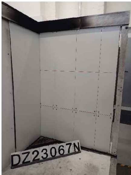
Foto 17: Prüfkörper DZ3.1/23-067N („K-284“), Ansicht des großen Flügels vor der Brandprüfung.
