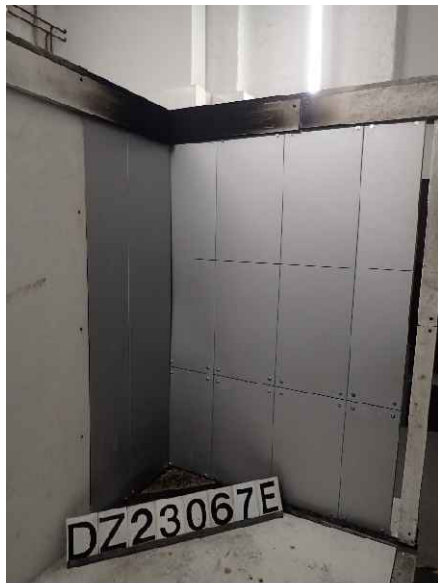
Foto 5: Prüfkörper DZ3.1/23-067E („K-284“), Ansicht des großen Flügels vor der Brandprüfung.
