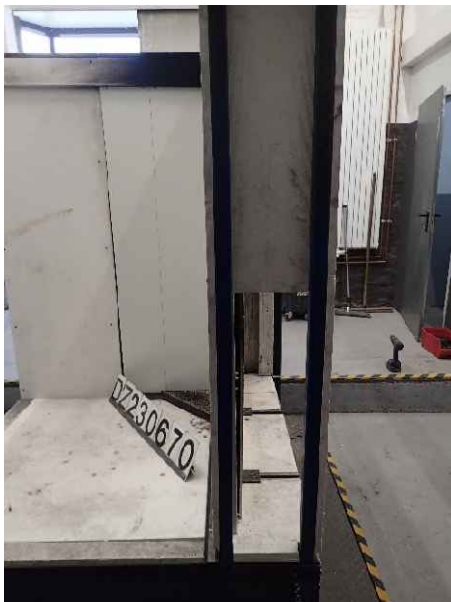
Foto 23: DZ3.1/23-0670 („K-284“), Ansicht des Luftspalts des großen Flügels vor der Brandprüfung.
