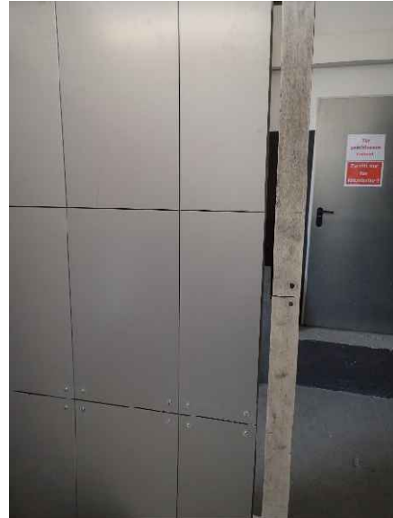
Foto 10: Prüfkörper DZ3.1/23-067F („K-284“), Detailansicht der Außenkante des breiten Probenflügels in Höhe von 500 mm in einem Winkel von ca. 45° vor der Brandprüfung.
