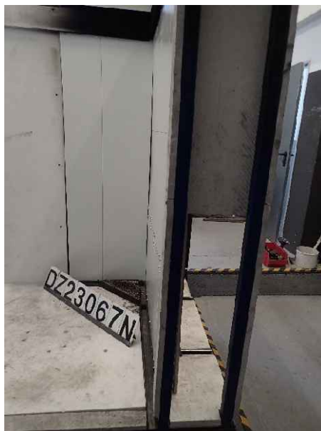
Foto 19: DZ3.1/23-067N („K-284“), Ansicht des Luftspalts des großen Flügels vor der Brandprüfung.
