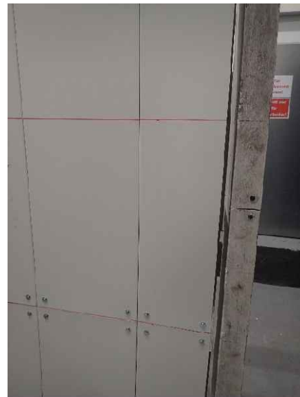
Foto 22: Prüfkörper DZ3.1/23-0670 („K-284“), Detailansicht der Außenkante des breiten Probenflügels in Höhe von 500 mm in einem Winkel von ca. 45° vor der Brandprüfung.
