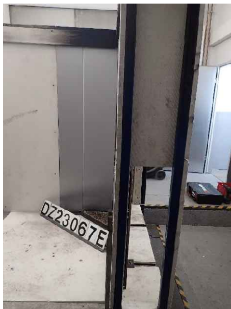
Foto 7: DZ3.1/23-067E („K-284“), Ansicht des Luftspalts des großen Flügels vor der Brandprüfung.
